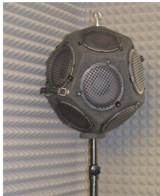
Wszechkierunkowe źródło dźwięku, wykorzystywane w badaniach akustycznych.
