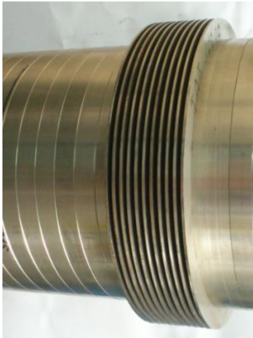
Wsad uszczelnienia labiryntowego z jedenastoma tarczami
