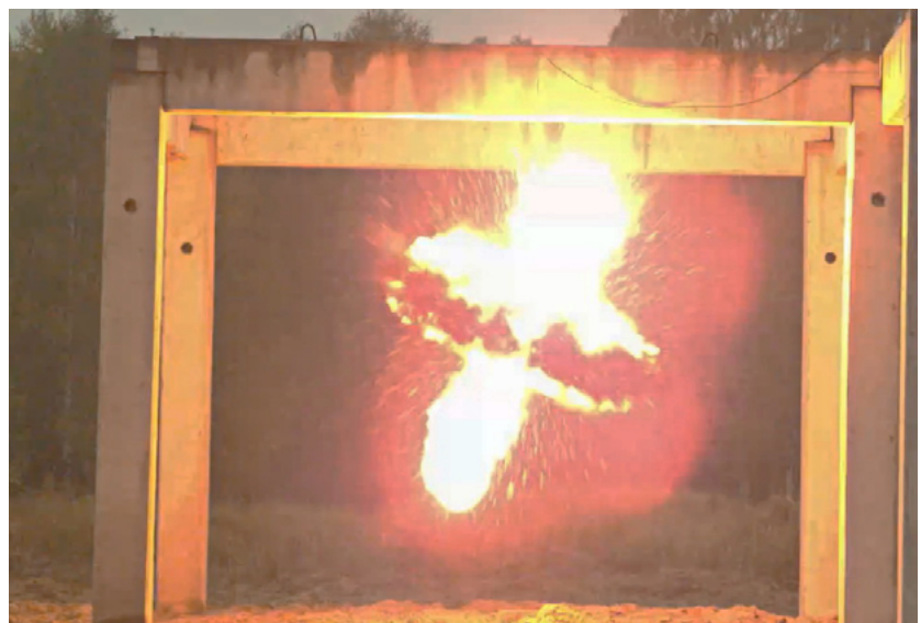
Zgodność pochłaniania energii przenośnych konstrukcji lekkiej obudowy (fot. P. Sielicki)
