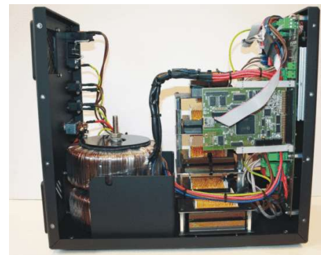
Zasilacz typu UPS do zastosowań o szczególnych narażeniach środowiskowych - wraz z modułem baterii Li-ION i systemem BMS
