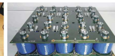
Zasilacz dużej mocy z podtrzymaniem napięcia wyjściowego po zaniku zasilania i moduł superkondensatorów (16 F/ 60 V) z systemem BMS
