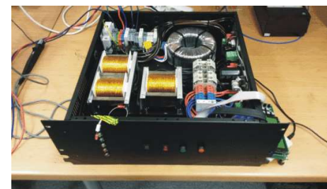
Zasilacz dużej mocy z podtrzymaniem napięcia wyjściowego po zaniku zasilania i moduł superkondensatorów (16 F/ 60 V) z systemem BMS
